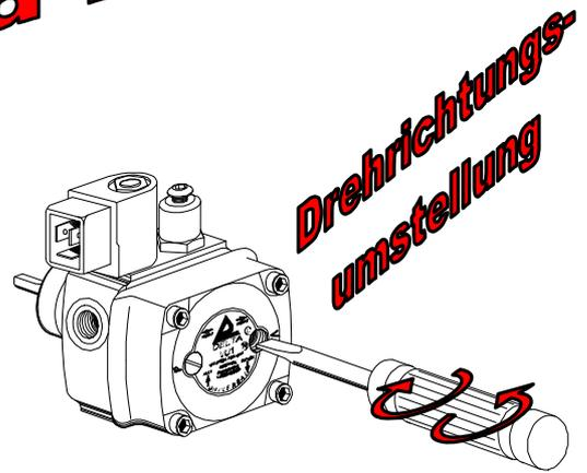
**Die Delta Universal Pumpe VU1 ist die einzige Pumpe, die eine Umstellung der Drehrichtung von Rechts- auf Linkslauf ohne Öffnen des Deckels nur mit Hilfe eines Schraubenziehers erlaubt!**
