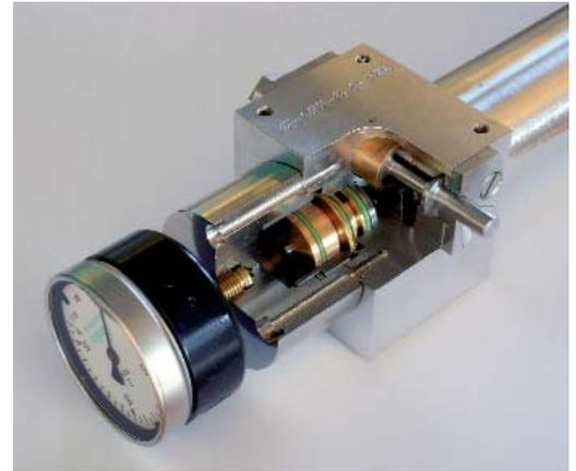
Alle Düsen werden vollautomatisch auf einem speziell entwickelten Meßsystem unter kalibrierten Bedingungen auf Sprühwinkel, Durchsatz und Sprühbild getestet. Die Sprühcharakteristik der Düsen wird durch ein modernes, optisch-digitales Meßsystem detailliert untersucht. Vom System werden dabei selbst kleinste Abweichungen erkannt, was zur Aussonderung der betreffenden Düse führt.
