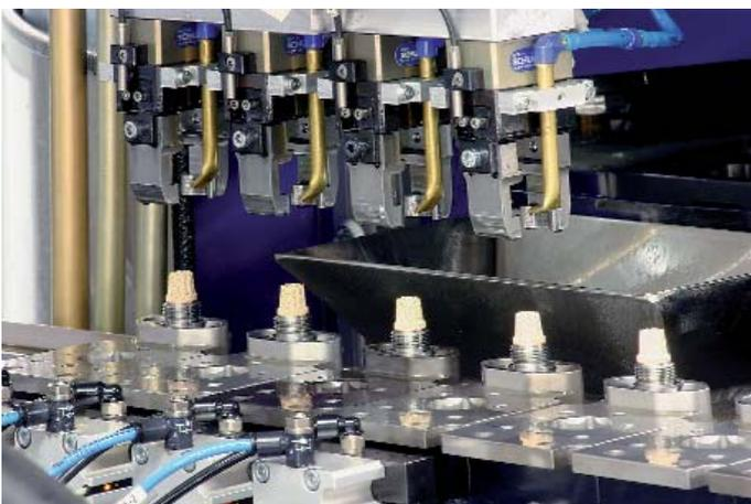
Nach der Stempelung und 100 % Kontrolle werden die Düsen automatisch in Schachteln und Kartons verpackt.
